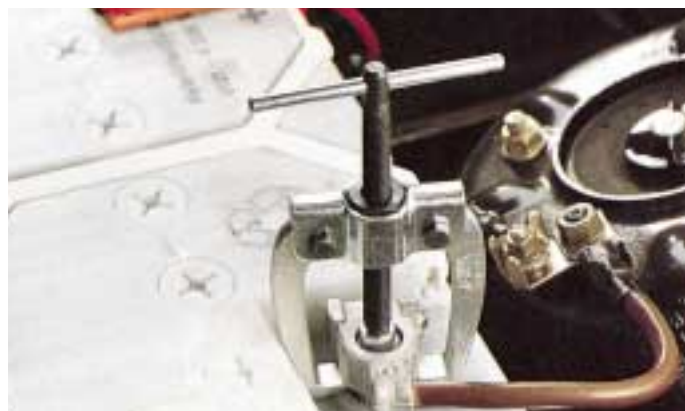
ściągacz do zdejmowania biegunów akumulatorów
