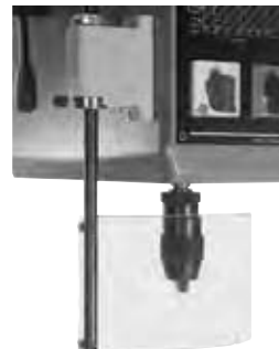
Ochrona wrzeciona włącznik z blokadą elektryczną.
